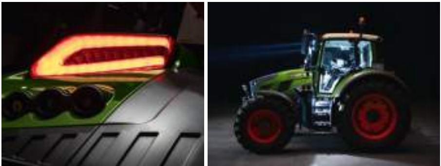
Nuove luci posteriori a LED (compatibili CAN) con indicatore di direzione a tergitura dinamica
